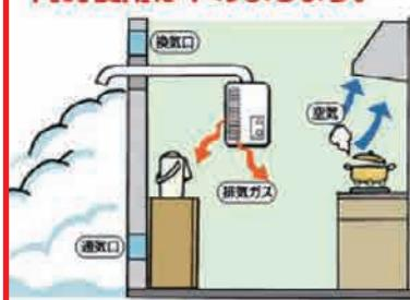
FE式燃焼器具と、レンジフード等を同時に使用すると、図のように燃焼器具の排気が逆流するおそれがあります。
