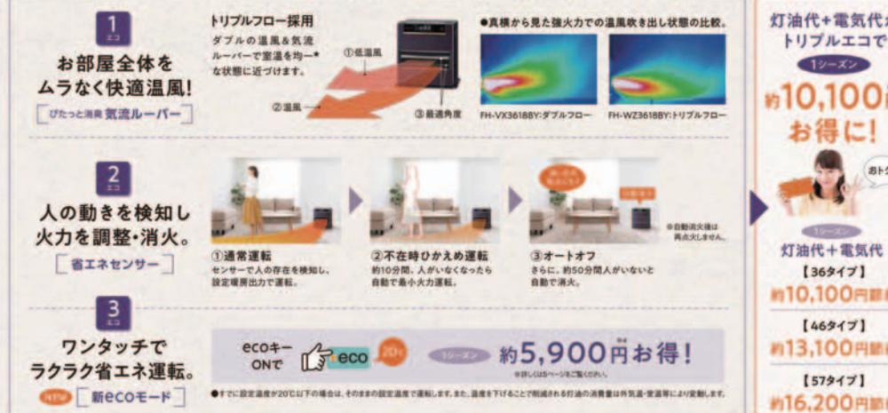
●試験条件: FH-WZ361BBYにおいて、ルーバースイング有無の比較。当社社屋環境試験室にて初期温度27℃から点火後の室温推移の比較。器具正面から1.5m離れた位置(高さ30cm, 80cm, 130cm)の温度を測定。
